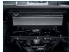
**Защитный кожух рулевой рейки**
